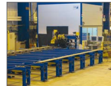
PEMA profiilien katkaisu- ja puhdistuslinja Technip Offshoren telakalla Mäntyluodossa
